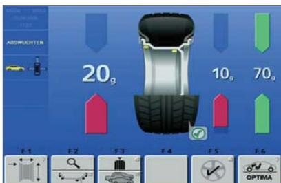
Alufelgen haben meistens Speichen, so dass Klebgewichte von außen sichtbar sein können. Um das zu vermeiden werden einfach per Tastendruck die Gewichte so aufgeteilt, dass sie hinter den Speichen platziert werden.
