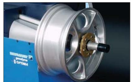
Wird eine Felge auf die geodyna optima aufgespannt und der Messlauf gestartet, erkennt die Maschine, dass es sich um eine Felge handelt und misst automatisch den Höhenschlag und den Seitenschlag der Felge. Die gemessenen Daten sowie der Hochpunkt der Felge werden auf dem Bildschirm angezeigt und können über den optionalen Drucker dokumentiert werden.
