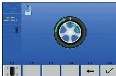
Das Rad wird jetzt abgespannt und auf der Montiermaschine die Kreidemarkierung auf dem Reifen zum Ventil gedreht. Schon ist die optimale Position des Reifens auf der Felge erreicht.
