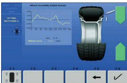
Der Bediener wird Schritt für Schritt durch den leicht verständlichen Matching-Prozess geführt. Hierbei wird der Reifen so zur Felge gedreht, dass sich die Unrundheiten von Felge und Reifen gegenseitig aufheben und dadurch die Laufruhe verbessert wird.
