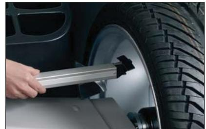
Nach dem Messlauf stoppt das Rad automatisch in der 12 Uhr Position. Der geodata Messarm führt den Bediener zur vorgeschlagenen Position des Klebengewichts und arretiert an dieser Stelle, so dass das Klebgewicht völlig sicher platziert werden kann.
